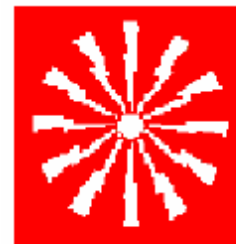
PULSANTE DI ALLARME ANTINCENDIO
